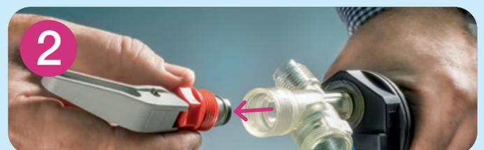
Kipphebeleinheit wird herausgeschraubt
