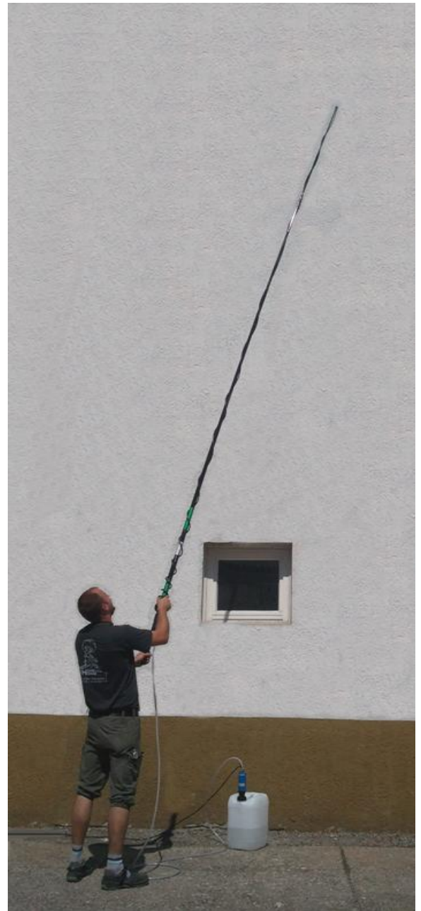
Teleskoplanze für das Arbeiten in bis zu 7 Metern Höhe
