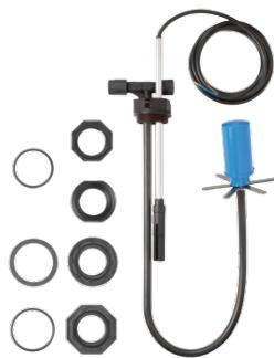
Zum Betrieb des Systems ist für jeden Folgetank ein Universal-Erweiterungssatz inkl. Grenzwertgeber erforderlich. Die Grenzwertgebersonde lässt sich im eingebauten Zustand der Armaturen für Kontrollzwecke demontieren. Die Armatur ist mit einer schwimmenden Absaugung ausgestattet und für Verbindungsleitungen von 8 und 10 mm vorgesehen.
